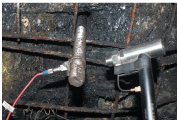
Fot. Układ pomiarowy oraz sposób mocowania przetwornika rejestrującego odpowiedź sygnału pokazano na powyższych zdjęciach.
