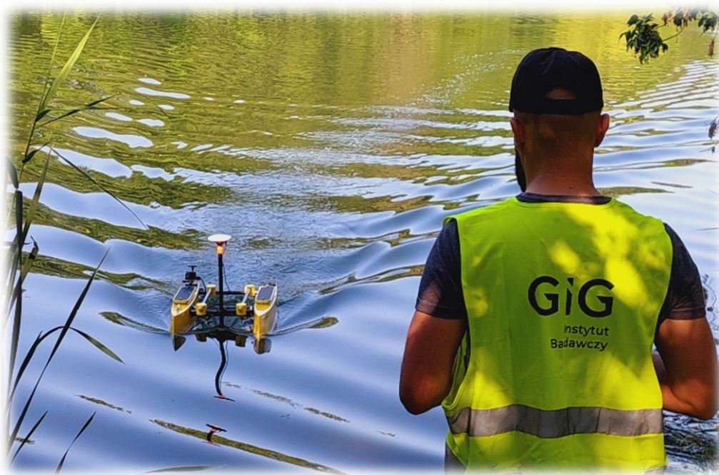
Fot. 5. Pomiary batymetryczne za pomocą platformy pływającej SHARKY firmy GeoPixel
