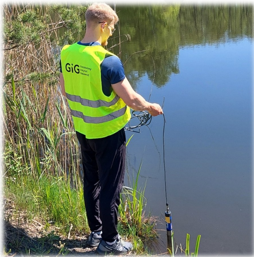
Fot. 4. Pomiar sondą In-Situ Aqua TROLL 500
