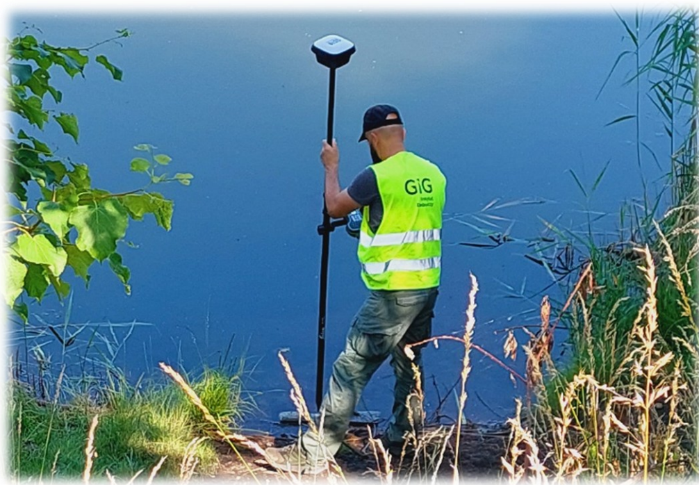
Fot. 3. Pomiar rzędnych zwierciadła wód odbiornikiem GPS GNSS
