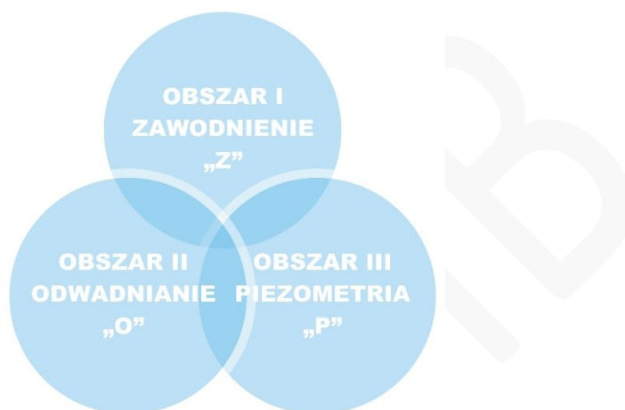
Rys. 1.1. Schemat systemu ZOP (system monitoringu zawodnienia oraz zmian odwadniania wyrobisk górniczych czynnych i zlikwidowanych kopalń w Górnośląskim Zagłębiu Węglowym: Zawodnienie – Odwadnianie – Piezometria)
