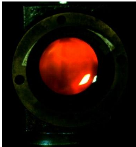
b) płomień wypenający wnętrze komory iskiernika
