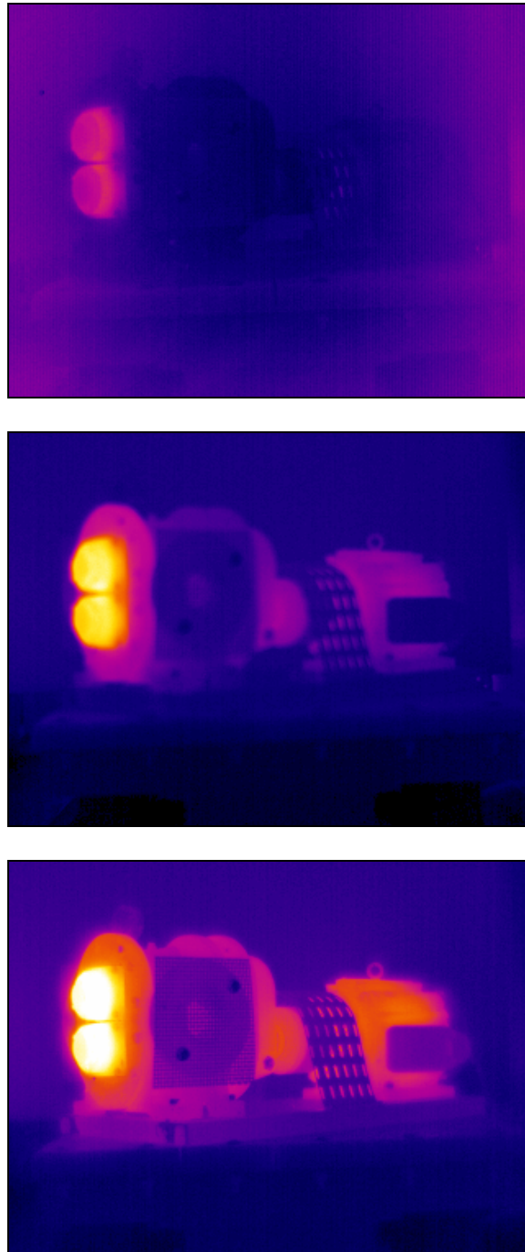
Rysunek 5: Sekwencja termogramów podczas próby nagrzewania pompy Roots'a.
