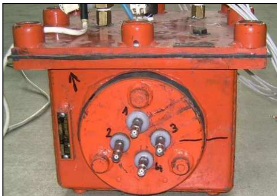
Fot. 2. Skrzynka testowa. Widoczne czujniki ciśnienia
