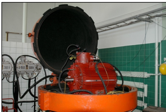
Rys. 2. Silnik w osłonie ognioszczelnej na stanowisku badawczym
