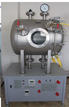
Rys. 8. Stanowisko do badania szczelności z wykorzystaniem helu
