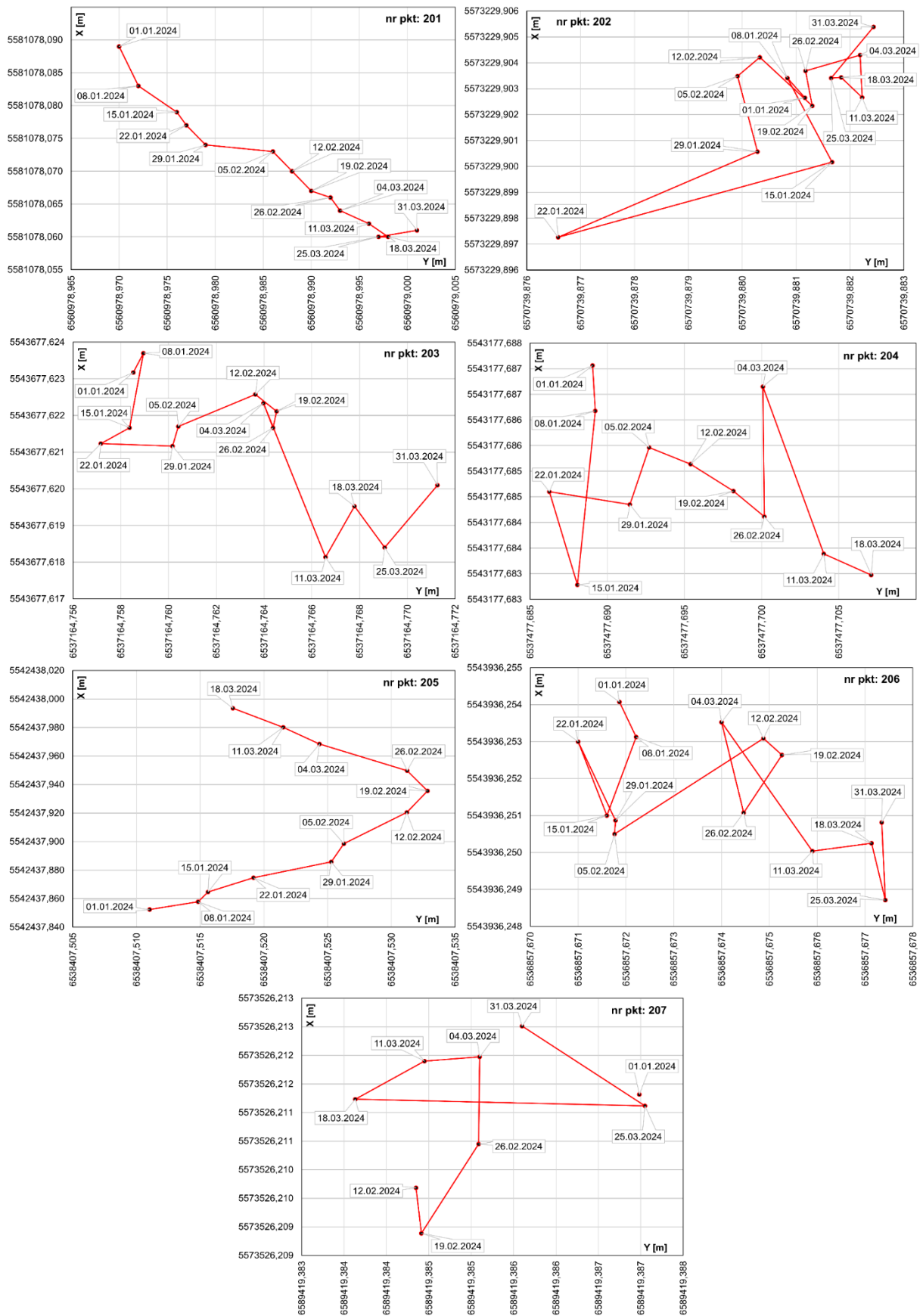
Rys. 12. Skumulowane poziome przemieszczenia powierzchni w 7-dniowym interwale czasowym, zmierzone metodą statyczną z wykorzystaniem permanentnych stacji GNSS, na punktach 201-207 w okresie 01.01.2024 – 31.03.2024.
