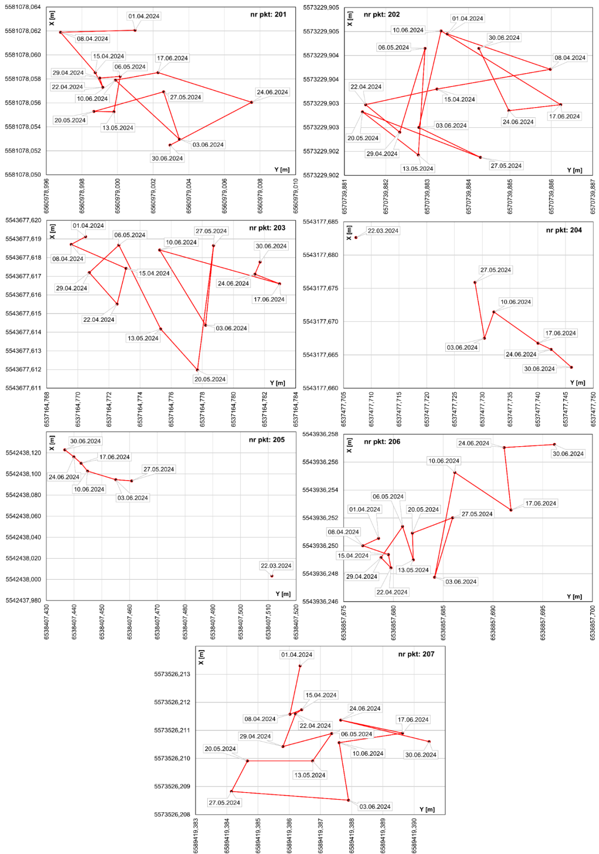
Rys. 11. Skumulowane poziome przemieszczenia powierzchni w 7-dniowym interwale czasowym, zmierzone metodą statyczną z wykorzystaniem permanentnych stacji GNSS, na punktach 201-207 w okresie 01.04.2024 – 30.06.2024.
