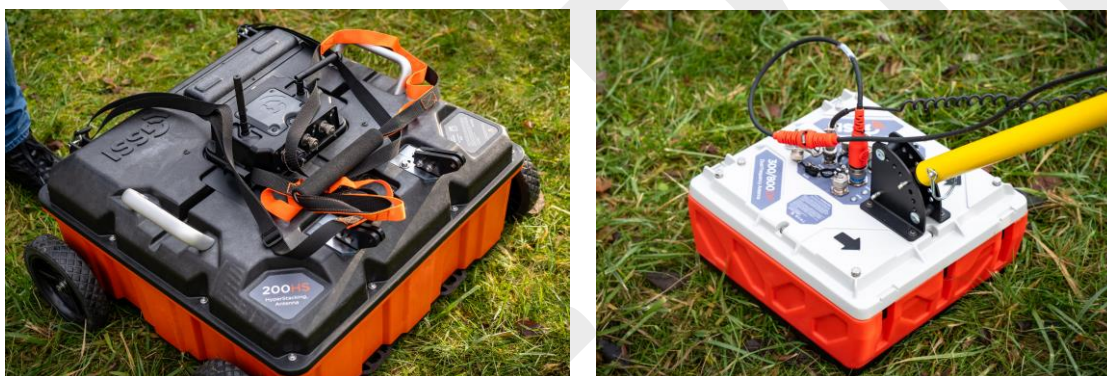
Fot. 3 Anteny 200 HS, 300/800 DF zestawu georadarowego GSSI SIR-4000.
