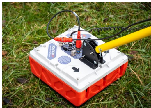
Fot. 3 Anteny 200 HS, 300/800 DF zestawu georadarowego GSSI SIR-4000.
