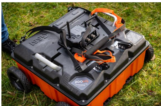
Fot. 3 Anteny 200 HS, 300/800 DF zestawu georadarowego GSSI SIR-4000.
