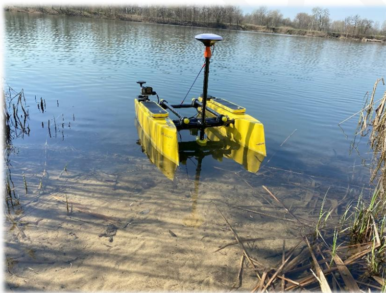
Fot. 4. Platforma pływająca do pomiarów batymetrycznych SHAKRY firmy GeoPixel
