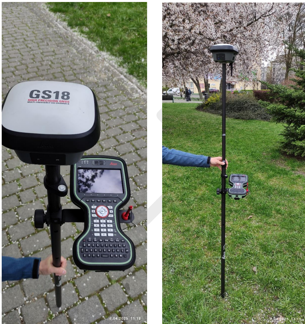
Rys. 6. Rejestrator GPS GNSS RTK Leica Geosystems GS18 T wraz z anteną.
