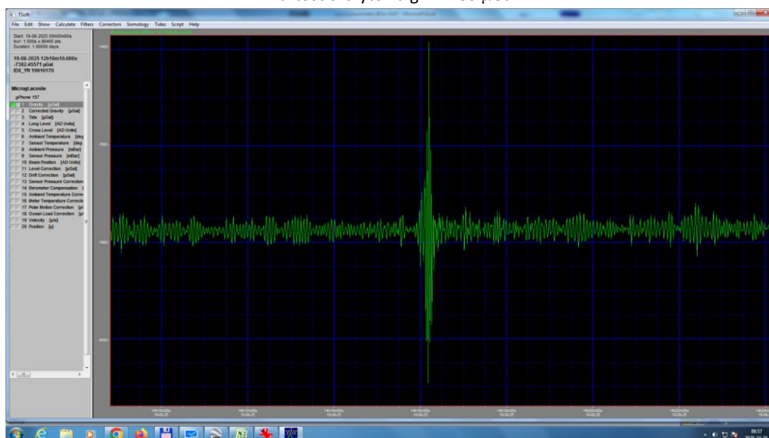
Rys. 5 Zapis wstrząsu z dnia 19.08.2025 przez stację GF1 w Katowicach ( M=3,3 ).
