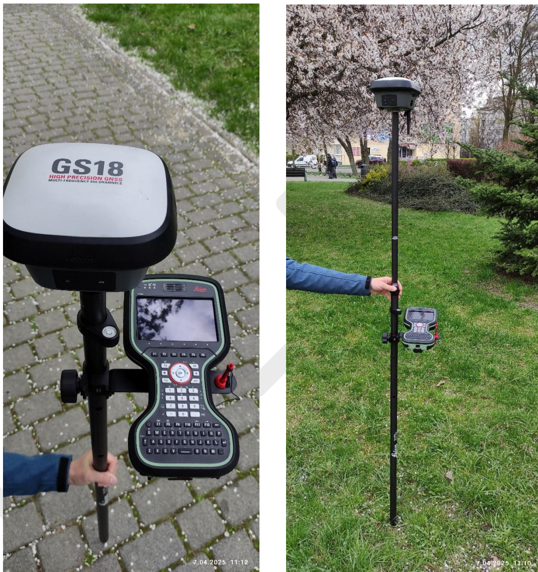
Rys. 8. Rejestrator GPS GNSS RTK Leica Geosystems GS18 T wraz z anteną.
