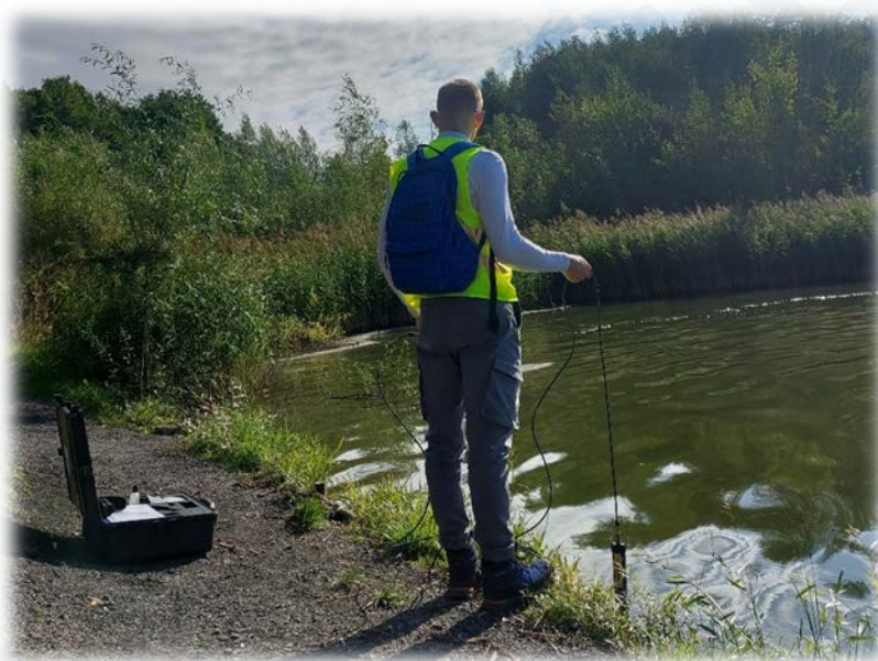
Fot. 3. Pomiar sondą In-Situ Aqua TROLL 500
