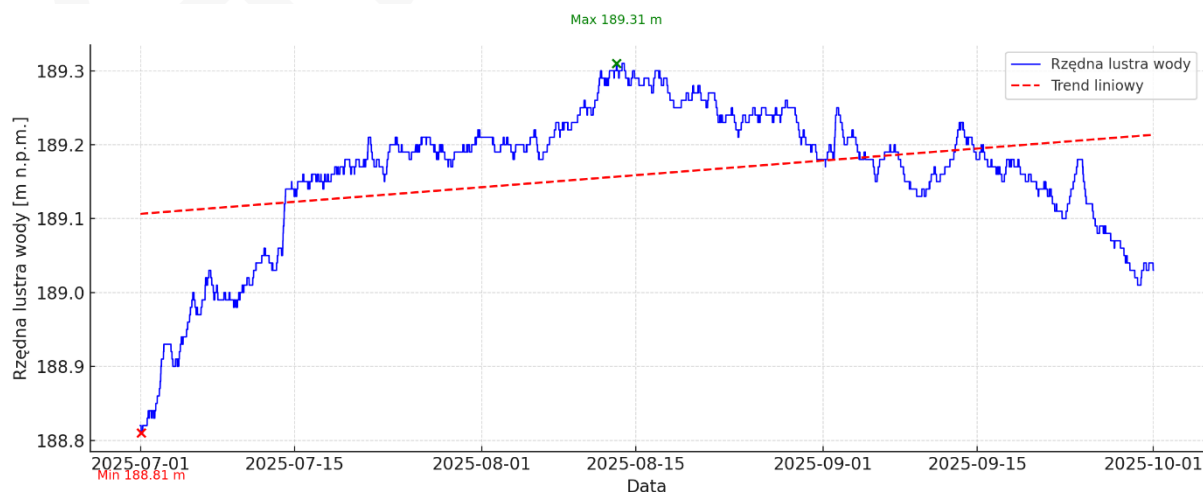
Rys. 4.3. Zmiany położenia zwierciadła wody w piezometrze P-1 w III kwartale 2025 r.
