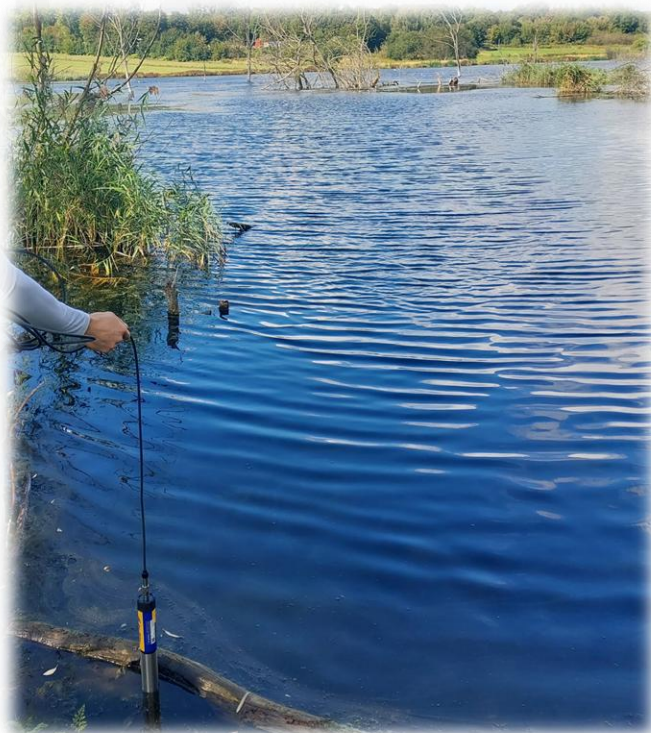
Fot. 3. Pomiar sondą In-Situ Aqua TROLL 500
