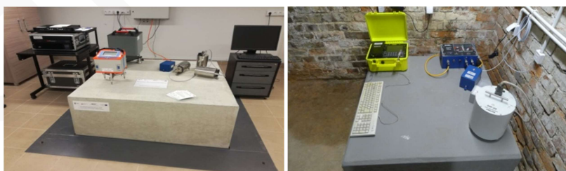
Rys. 2 Przykładowe stacje sejsmiczne GRSS w GIG-PIB oraz na terenie zabytkowej kopalni Ignacy (Fot. G. Mutke)
