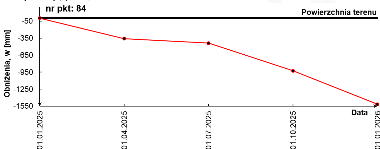
Rys. 11. Pionowe obniżenia powierzchni terenu w funkcji czasu, zmierzone metodą RTN z wykorzystaniem ruchomego odbiornika GNSS, na punkcie nr 84 w okresie od 27-31.12.2024 do 29-31.12.2025 r.
