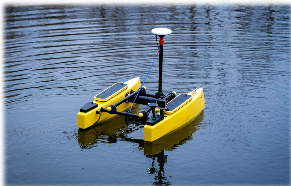
Fot. 5. Pomiaru batymetryczne za pomocą platformy pływającej SHARKY firmy GeoPixel
