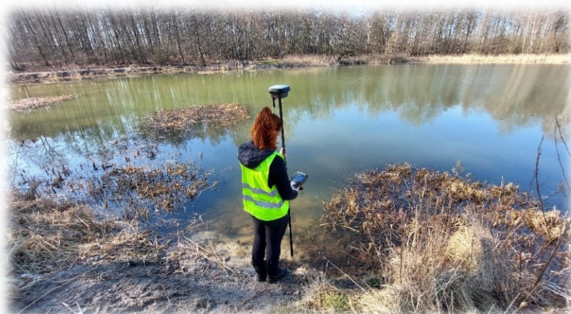
Fot. 3. Pomiar rzędnych zwierciadła wód odbiornikiem GPS GNSS
