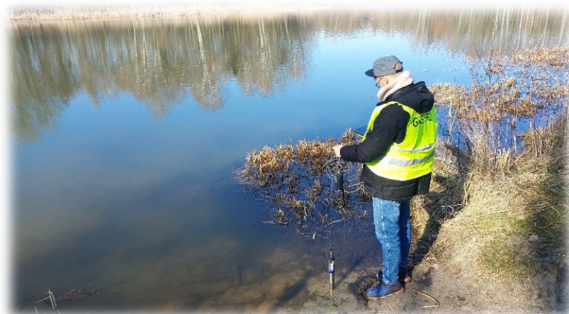
Fot. 4. Pomiar parametrów fizyko-chemicznych wód sondą In-Situ Aqua TROLL 500
