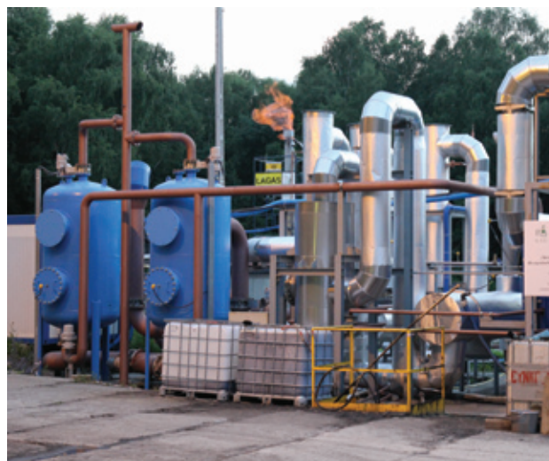
Fot. Instalacja do ciśnieniowej symulacji procesu podziemnego zgazowania węgla
