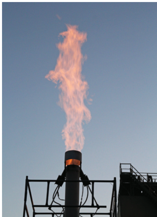
Fot. Instalacja do ciśnieniowej symulacji procesu podziemnego zgazowania węgla
